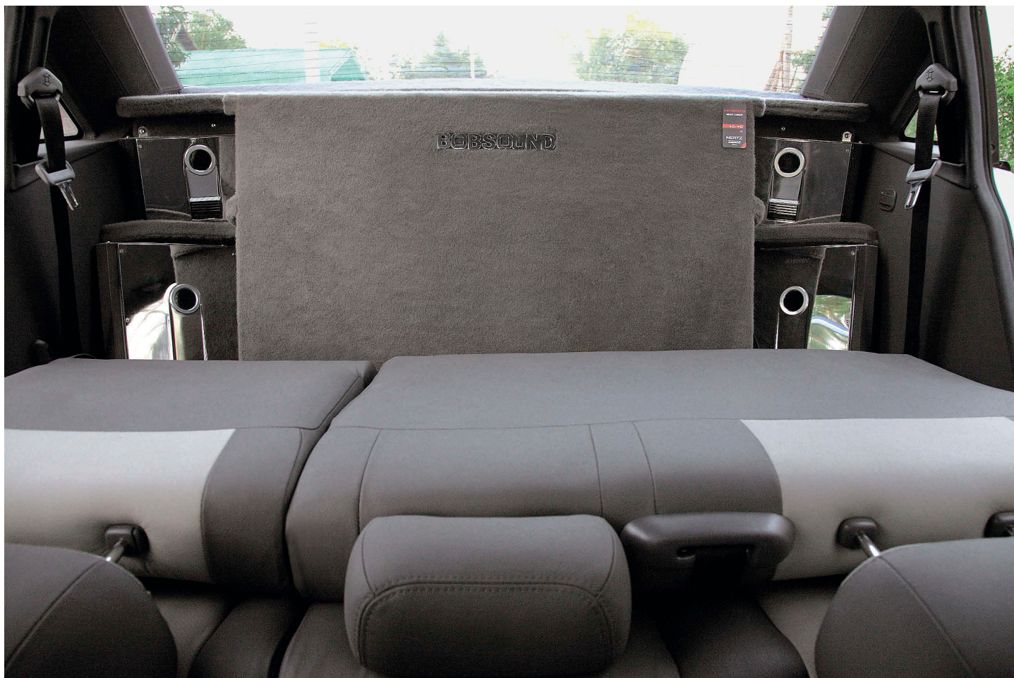
Под задней полкой новорожденного седана сабвуфер-бандпасс под конвоем из четырёх «Аудиобанов»
