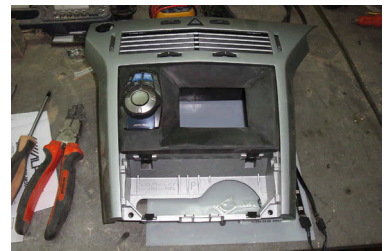
В габаритах ампутированного штатного ГУ была сделана рамка под новую начинку
